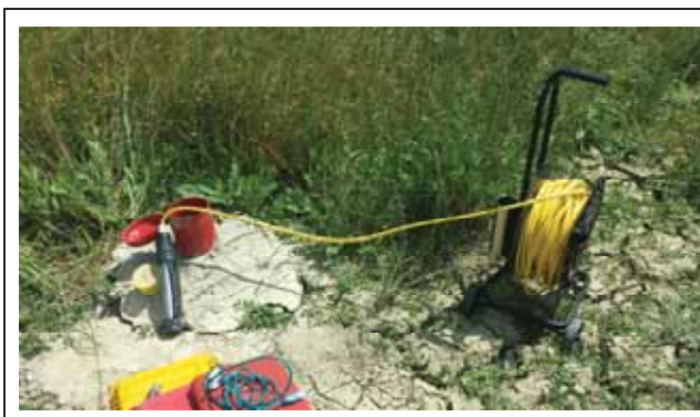
Fig. 2 – Geofono da foro a 5 componenti
